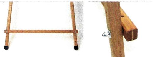
Am unteren Ende der Holme wird je eine Gummikappe aufgesteckt.
